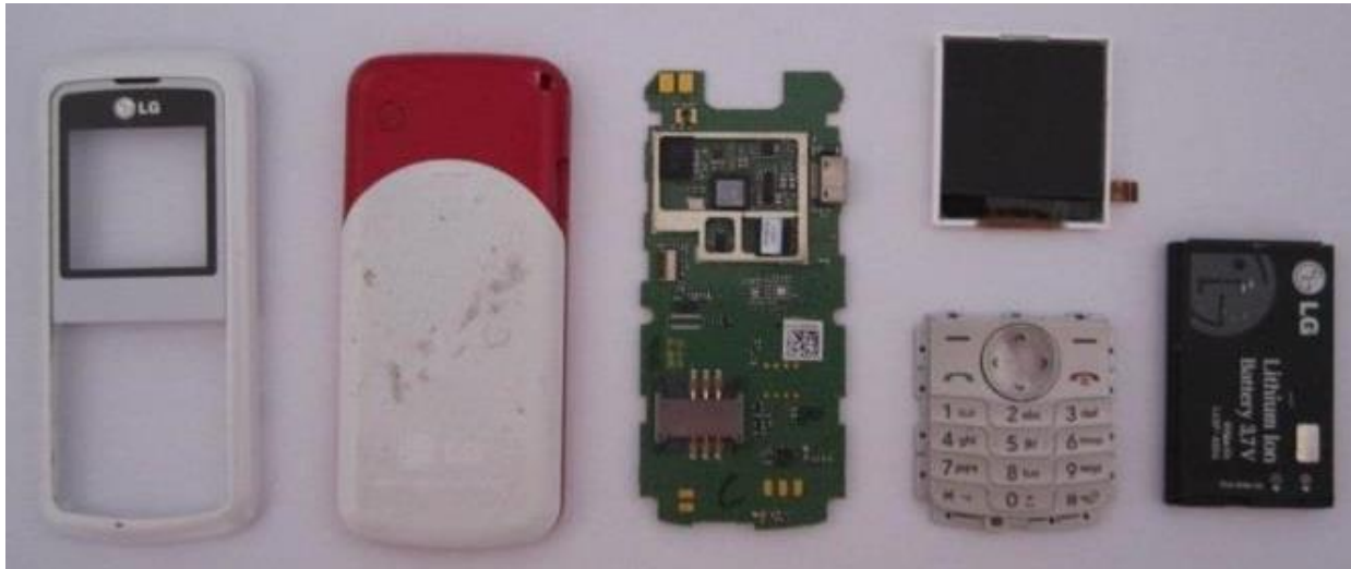
Esempio di telefono cellulare disassemblato nelle sue parti principali
